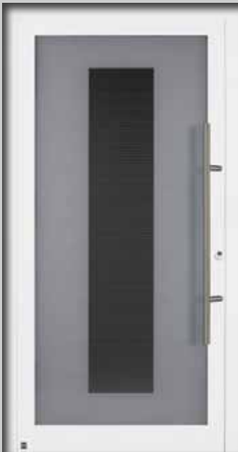
Modelo 100 / MG 112 Tirador de acero inoxidable 38-1, acristalamiento de diseño en el exterior VSG mateado con un rectángulo transparente, Micrograin en el centro, VSG transparente en el interior, valor U_D de hasta 1,6 \text{ W}/(\text{m}^2\cdot\text{K})^*
